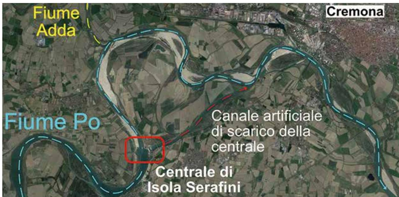
**Fig. 6** - Lo sbarramento artificiale e la centrale idroelettrica di Isola Serafini (Cr). La centrale è stata realizzata in seguito al taglio di meandro del fiume Po avvenuto nel corso dell'alluvione del 1951 (immagine Google Earth).
