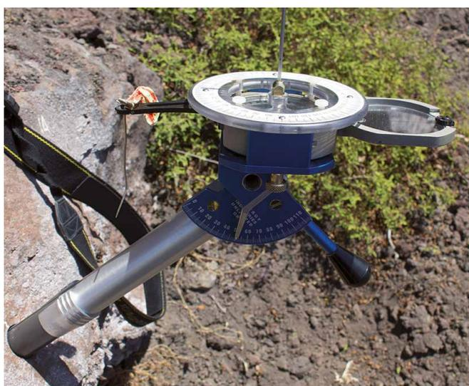
Fig. 6 - Tubo orientatore munito di inclinometro, bussola magnetica e bussola solare.
