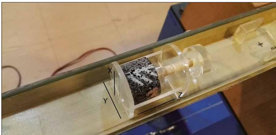
Fig. 7 - Campione alloggiato nel porta-campioni e pronto per la misura paleomagnetica al magnetometro criogenico presso il Laboratorio di Paleomagnetismo dell'INGV (Roma).
