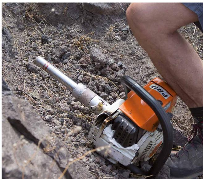
Fig. 5 - Perforatore a miscela raffreddato ad acqua con punta diamantata.
