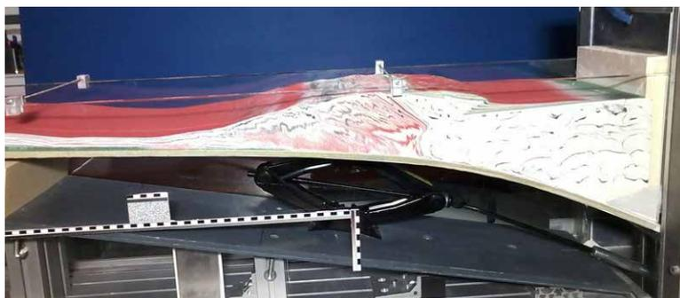
**Fig. 1** - Apparato sperimentale allestito nel laboratorio dell'istituto Geosciences Montpellier utilizzato per modellizzare analogicamente l'evoluzione della catena appenninica siciliana.
