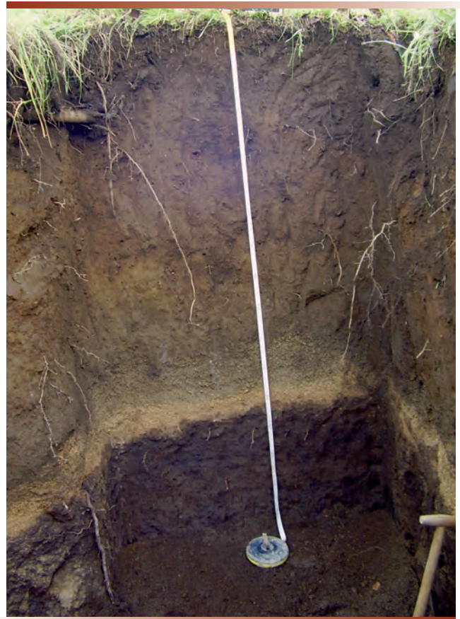
Figura 1 - Profilo di un suolo dell'areale di Lapio (AV), regione Campania, sede della prestigiosa Denominazione di Origine Controllata e Garantita (DOCG) del Fiano di Avellino. Nel profilo visibili i depositi da caduta ascrivibili all'eruzione del Somma-Vesuvio denominata: Pomice di Avellino (4360±40 anni or sono).
