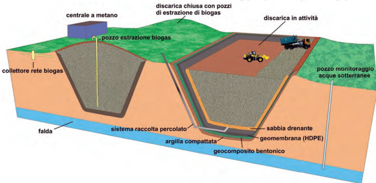
Schema concettuale di una discarica in attività e di una discarica chiusa con captazione di biogas.
